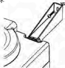
**Примечание:** при перемещении или чистке диспенсера извлекайте винты, которыми крепится устройство.
