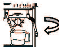
8. Через форсунку в течение 1 минуты будет поступать горячая вода, после чего пользователь может очистить её с помощью специальной щётки.
