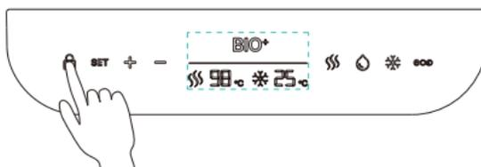
**Настройка температуры воды.** Горячая вода - разблокируйте панель, удерживайте "SET" в течение 3 секунд, мигнет сигнал подачи горячей воды, нажмите +/- для установки температуры горячей воды. Холодная вода - удерживайте "SET", мигнет сигнал подачи холодной воды, нажмите +/- для установки температуры холодной воды. Настройка будет подтверждена через 3.
