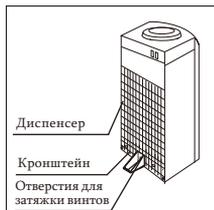
**Примечание:** при перемещении или чистке диспенсера извлекайте винты, которыми крепится устройство.
