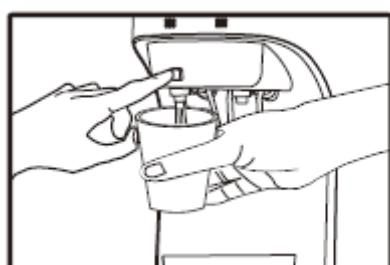
12. Установите на место крышку бака холодной воды в сборе. Откройте кран подачи воды в водораздатчик. Проверьте подачу воды из крана холодной воды. Если вода не течёт, нажмите, пожалуйста, кнопку для стравливания воздуха из бака холодной воды. Проверьте подачу воды из крана горячей воды. Вода должна идти непрерывной струёй. Установите на место верхнюю панель.
