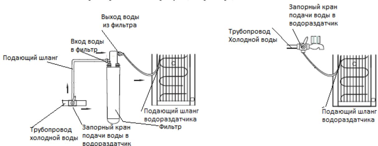
Водораздатчик необходимо подключать к трубопроводу **холодной воды**. Для этого вам потребуется расположенный вблизи места установки водораздатчика запорный кран холодной воды, к которому можно подключить переходник для подключения полипропиленового трубопровода (шланга) с
