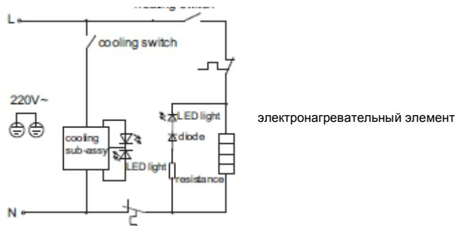
термопеле для защиты от сухого обогревания (с ручным перезапуском)
