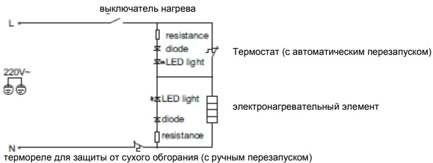
D26WF - Принципиальная электрическая схема
