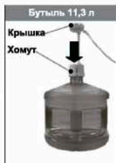
Рис.3 Установка сифона на бутылку с водой
